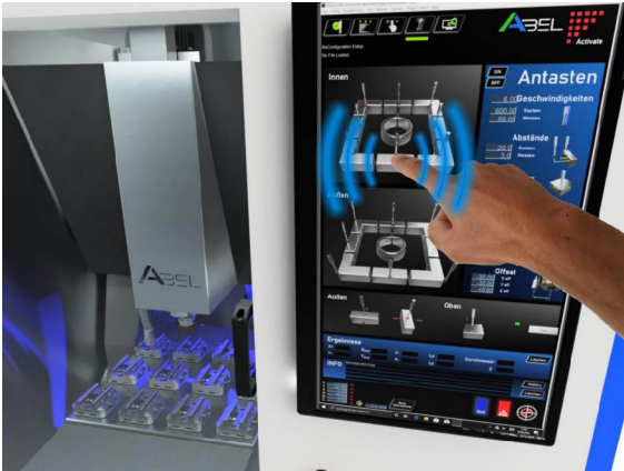
Intuitive Steuerung des 3D-Tasters per Bedienterminal
